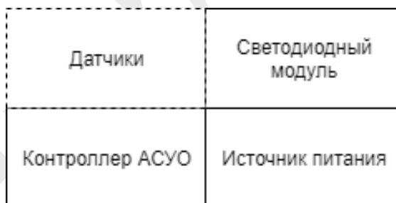
Рисунок 3 – Функциональная схема осветительного прибора
