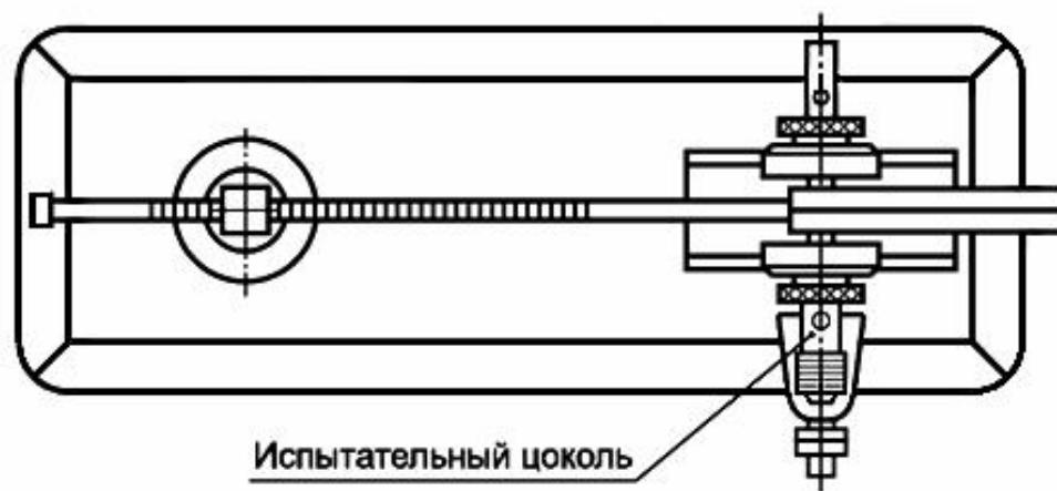
Рисунок 6 - Установка для проверки на скручивание
