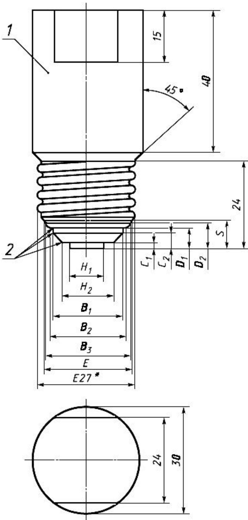
1 - твердая сталь; 2 - острые кромки притупить
