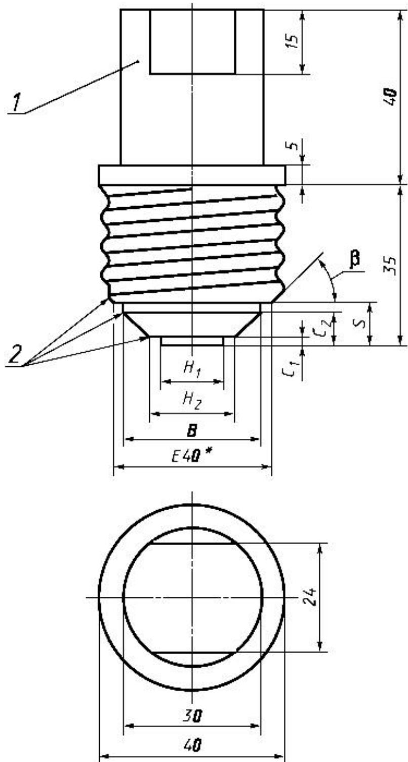
1 - твердая сталь; 2 - острые кромки притупить
