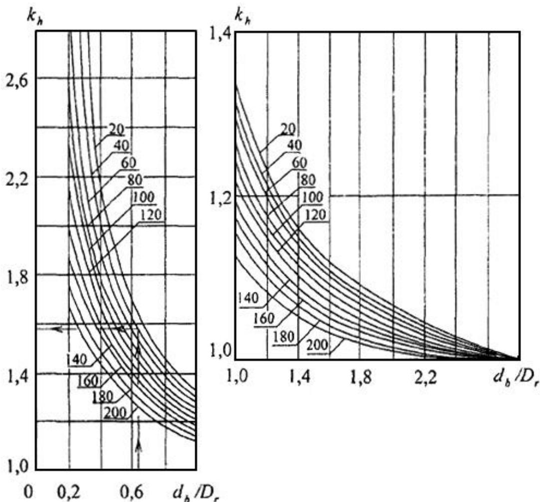
Рисунок Г.1 - График для определения коэффициента  $k_h$  жесткого массива. Цифрами на кривых указан коэффициент постели слоя основания  $K_{sr}$ , МН/м<sup>3</sup>, лежащего на жестком массиве
