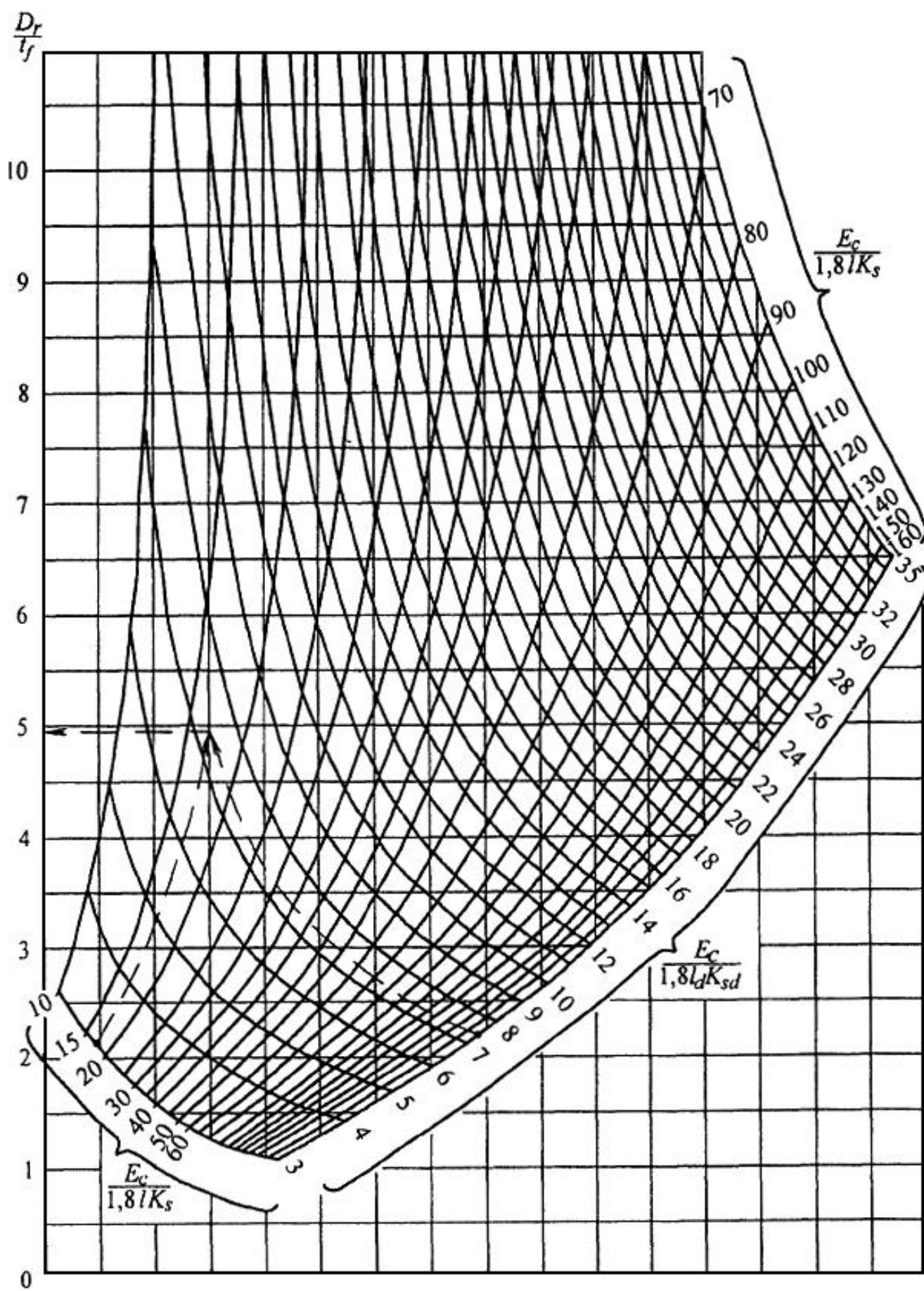
Рисунок М.2 - Номограмма для определения соотношения  $\frac{D_r}{t_f}$
