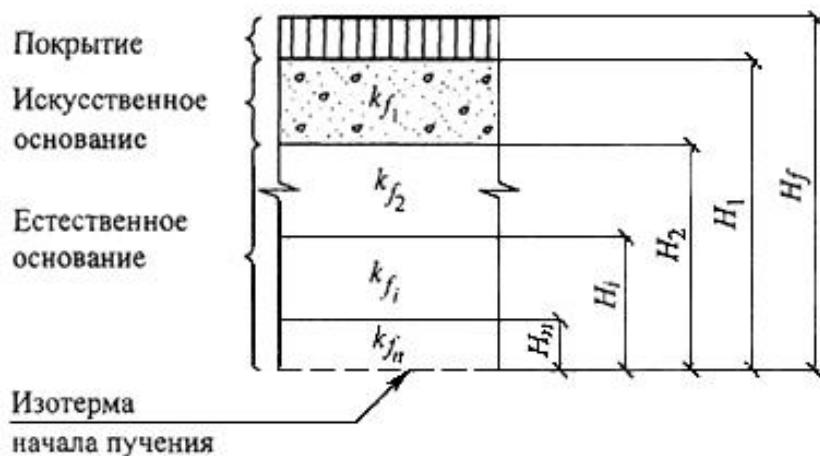
Рисунок Е.1 - Расчетная схема слоистого основания
