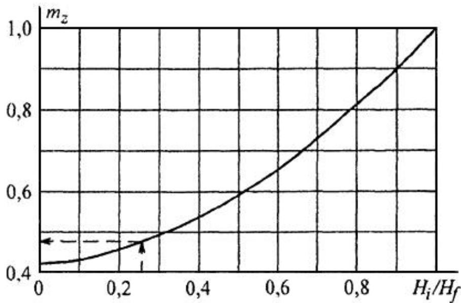
Рисунок Е.2 - График для определения коэффициента  $m_z$
