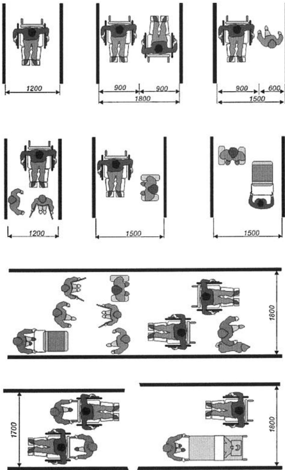
Рисунок В.14 - Параметры и пропускная способность коридоров
