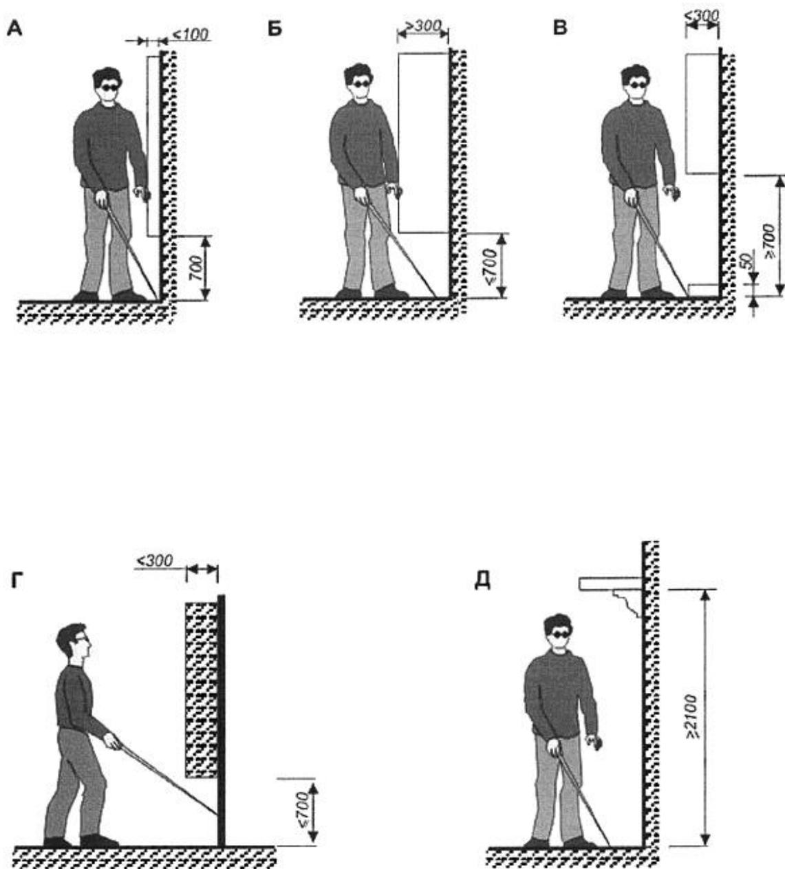
А, Б - допустимые параметры вертикальных преград, размещаемых параллельно стене;
