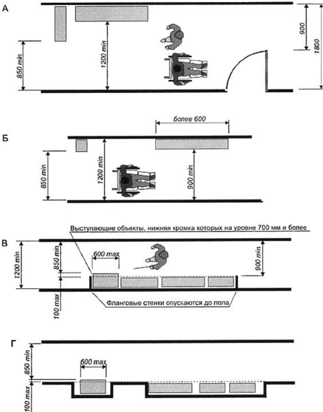
А, Б - сохранение пропускной способности коридоров; В - безопасное размещение смонтированных на стене объектов; Г - заглублиение объектов в нишу
