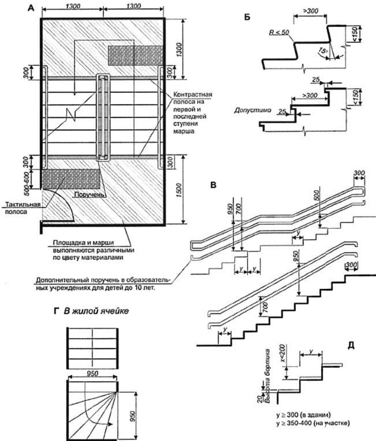
А - минимальные параметры лестничной клетки; Б - максимальные параметры ступени; В - принцип устройства поручня в общественных местах; Г - допустимые параметры внутренней лестницы в жилой ячейке; Д - соотношение ширины проступи и высоты подступенка
