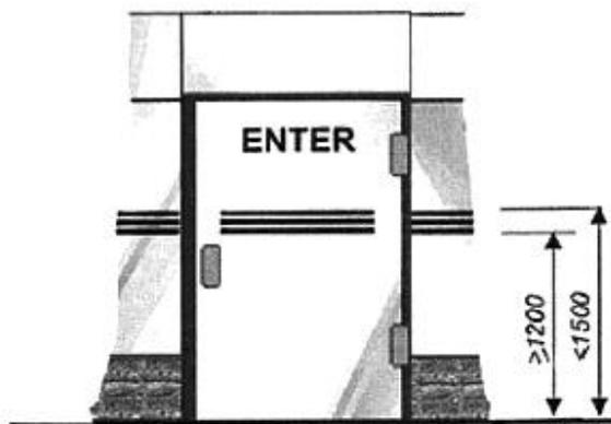
*Варианты маркировки дверей и дверных проемов*
