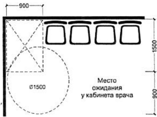
**Рисунок В.8 - Примеры расстановки оборудования в кабинетах поликлиник и амбулаторий**
