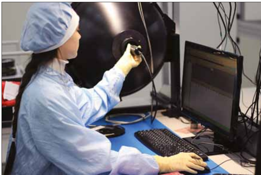
Выборочное тестирование и измерение параметров светодиода
