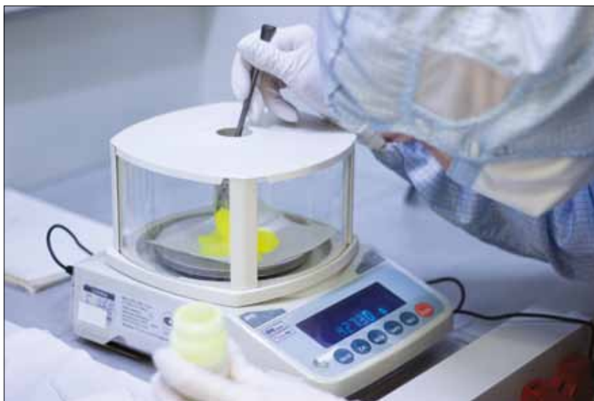
Подготовка силикон-люминофорной смеси
